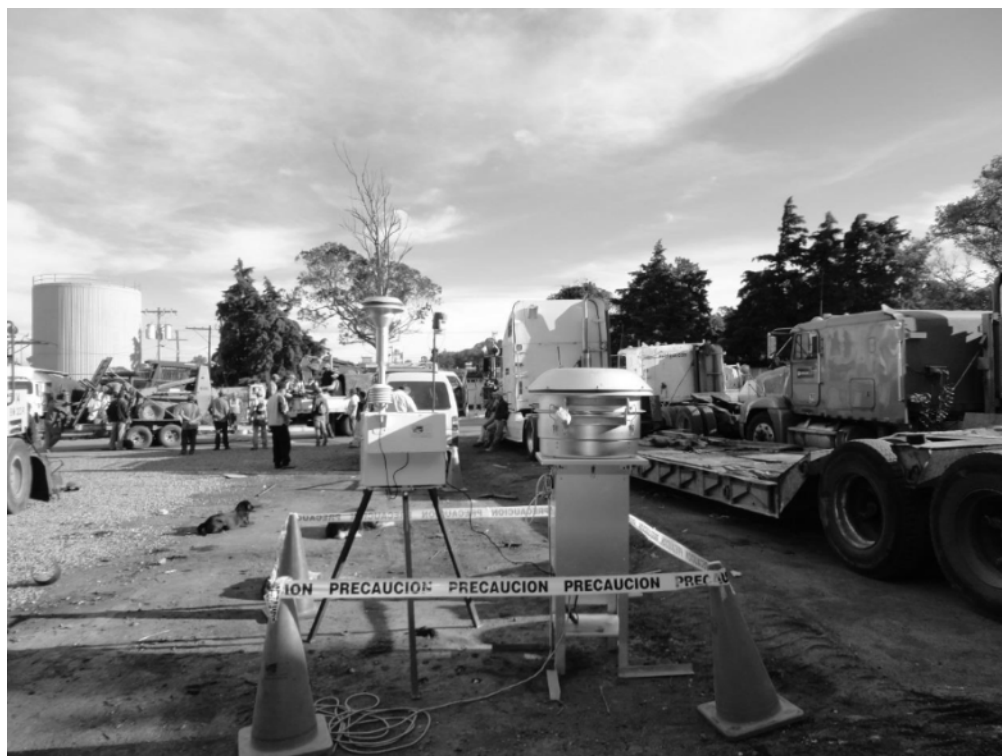
Fotografía 2. Equipo de medición de calidad del aire en una planta de mezclas asfálticas
